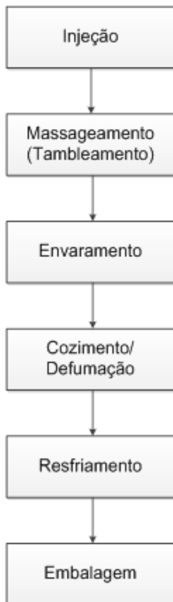
Figura 1. Fluxograma simplificado do processamento do Bacon defumado
