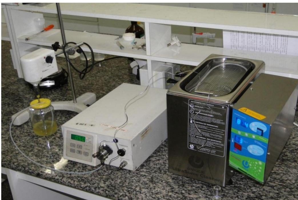
O procedimento experimental consistiu no empacotamento do reator com a enzima, sob a ação de um agitador magnético, a fim de realizar um empacotamento mais eficiente, conforme Dalla Rosa (2009).
