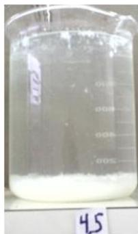
Condição otimizada em  $\text{pH}_{\text{inicial}} 6,2$  ( $\text{Al}_2\text{SO}_4)_3$
