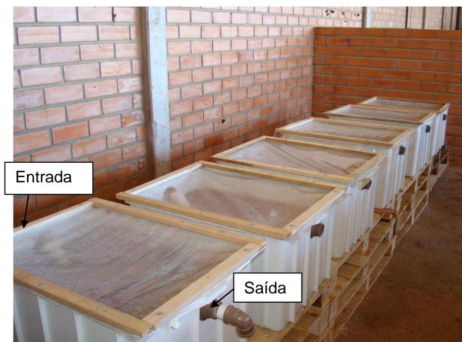
Figura 4 - Biodigestores Piloto montados no local do experimento.
