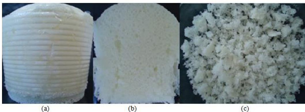
Figura 16. Aspecto da espuma de PU formada juntamente com a lipase Cal B na forma líquida (EH) sendo (a) Imobilizado na forma íntegra (b) Corte longitudinal do imobilizado (c) Imobilizado triturado.
