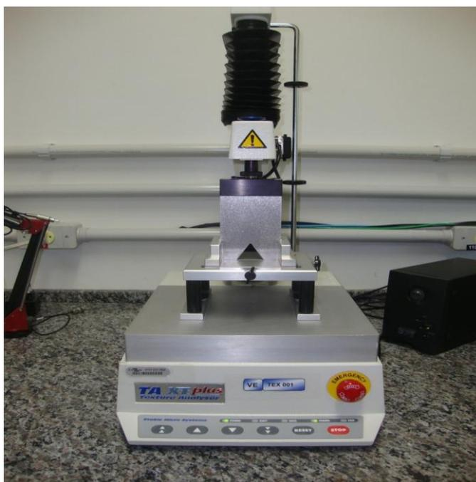
**Figura 10.** Equipamento utilizado para realização da análise de textura.
