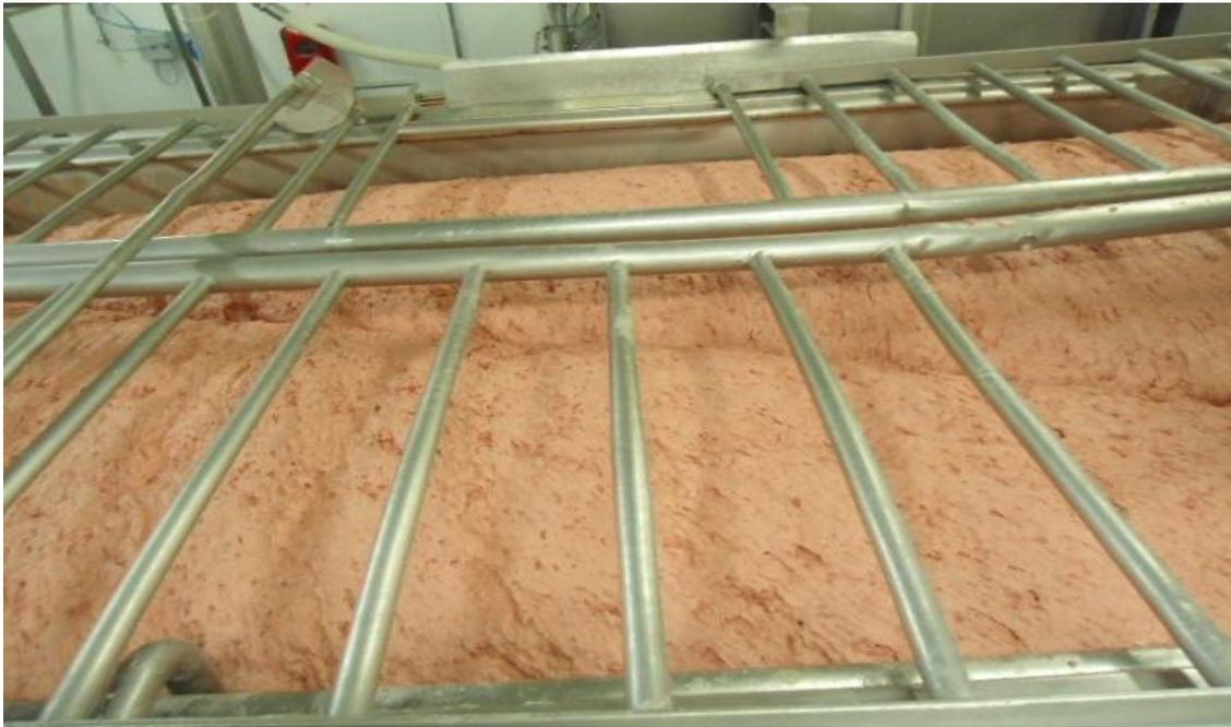
**Figura 4.** Equipamento de mistura das matérias-primas, ingredientes e aditivos.
