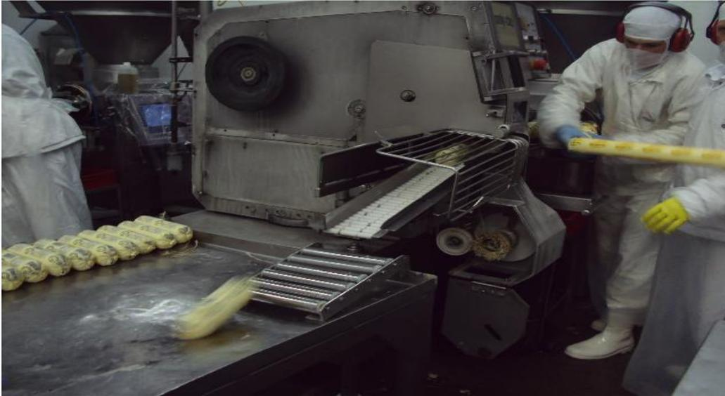
**Figura 8.** Processo de embutimento das peças de mortadelas de frango.
