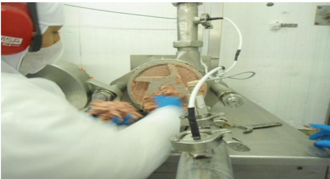
**Figura 7.** Emulgador, usado para emulsificação da massa das mortadelas de frango, sem a tampa de entrada da massa.
