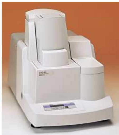
**Figura 3.** Aspecto visual do termogravímetro (TG-DTG 60H- SHIMADZU).
