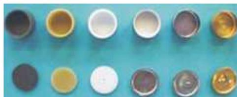
**Figura 6.** Aspecto dos cadinhos utilizado no DSC (grafite,  $ZrO_2$ ,  $Al_2O_3$ , Pt +  $Al_2O_3$  inside layer Pt, Au) (SKOOG et al., 1992).
