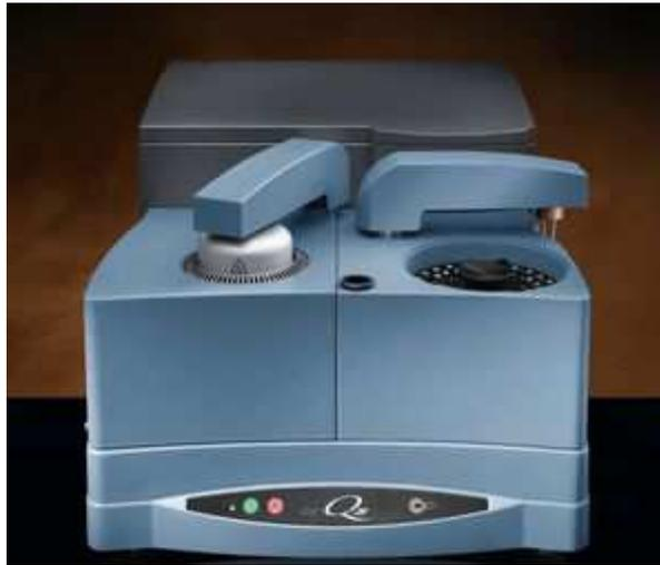
**Figura 5.** Aspecto visual do calorímetro (TA Instruments, Modelo Q20).
