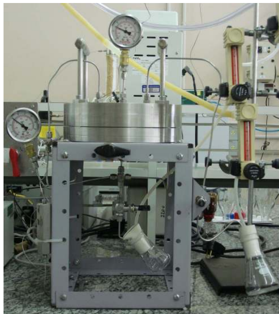
Figura 3.3 Detalhe do módulo de separação com membranas, os rotômetros e os frascos coletores.
