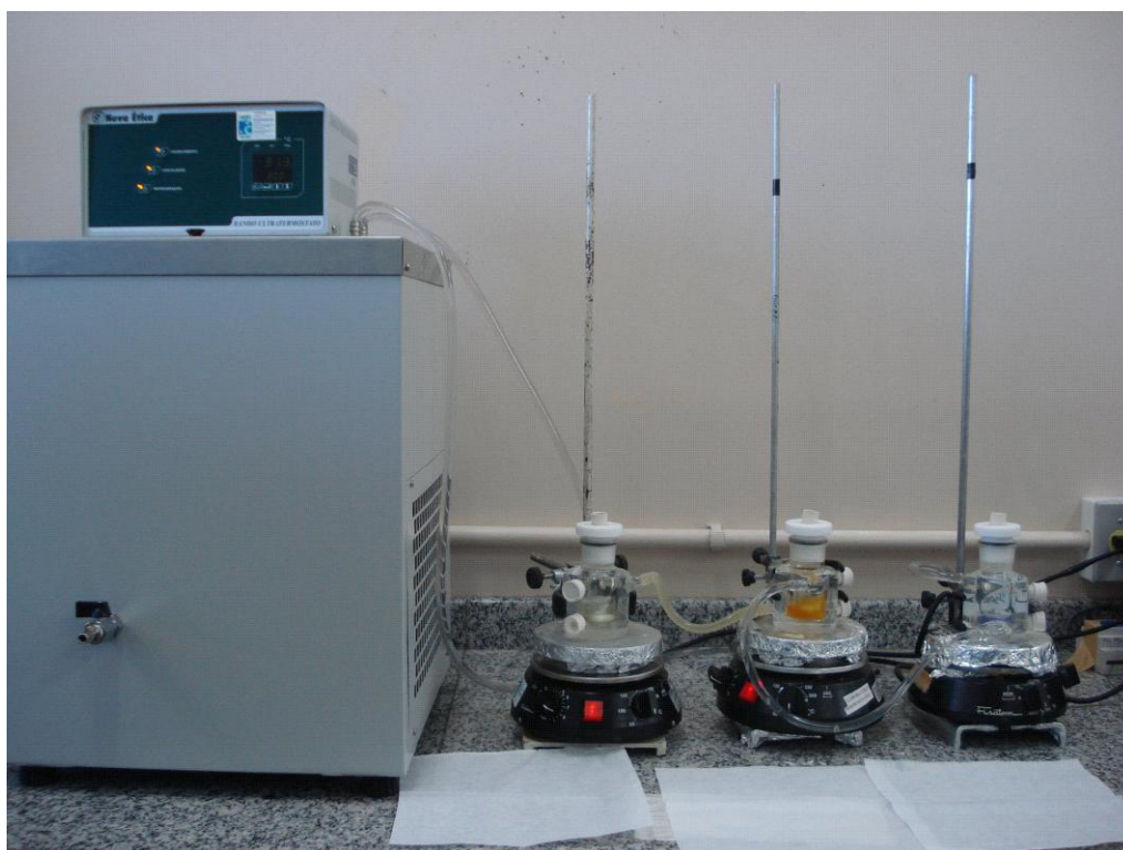
Figura 17 - Unidade experimental de bancada utilizada para as reações de oxidação.
