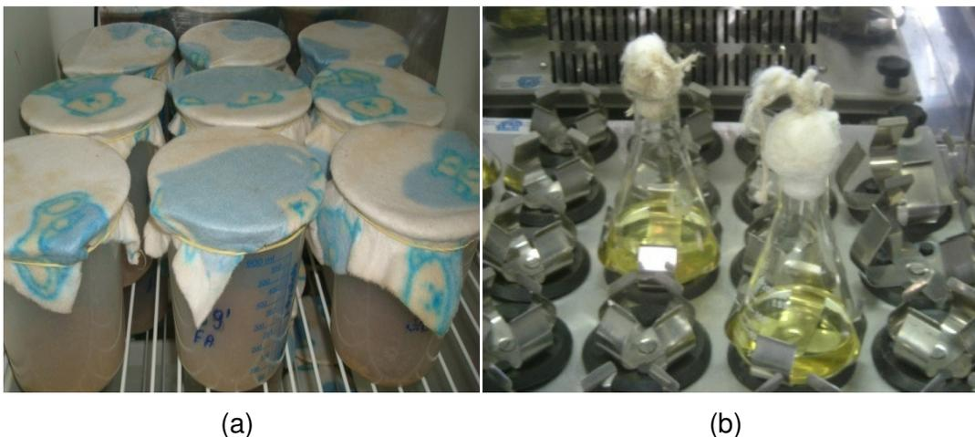
**Figura 1.** Representação do processo de produção de enzimas por fermentação em estado sólido (a) e fermentação submersa (b). (Fonte: Registro feito durante experimentos).
