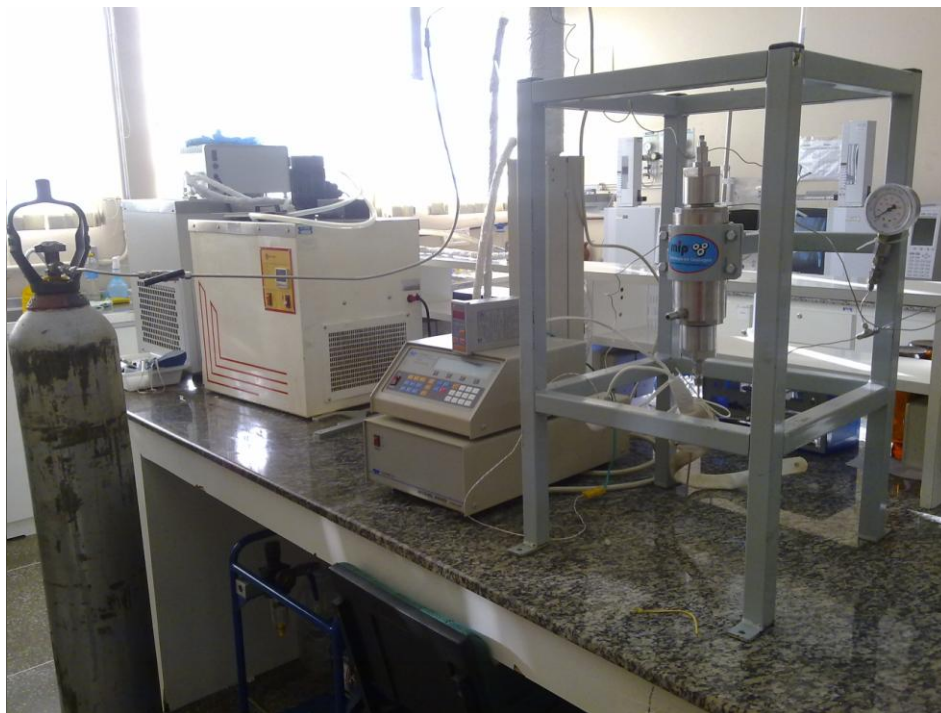
Figura 16 - Foto da unidade experimental a alta pressão (extrator) utilizado para obtenção dos dados.
