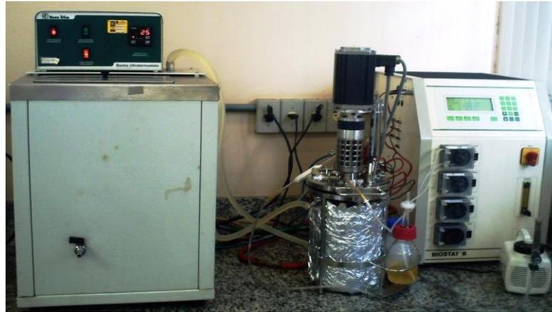
**Figura 10** - Biorreator utilizado na bioprodução de carotenoides.
