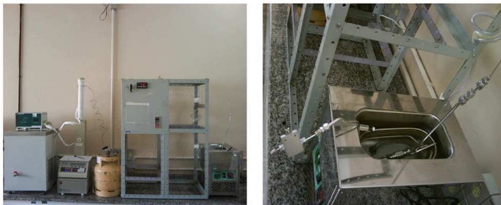
Figura 6 – Vista da unidade experimental utilizada no tratamento enzimático (a) e da célula já acoplada a unidade experimental e mergulhada no banho termostático (b).
