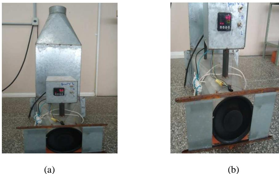
Figura 8 – Secador piloto convectivo (a) e detalhe do sistema de ventilação com controle de temperatura do ar (b).
