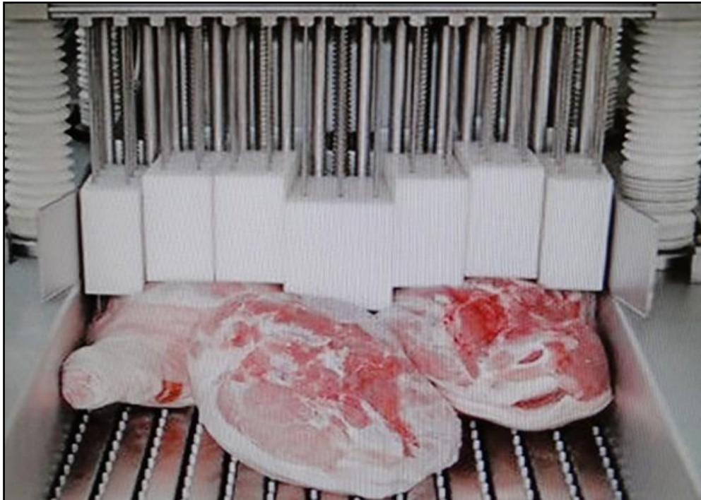
Figura 03 - Máquina injetora de temperos utilizada para fazer a injeção das carnes.
