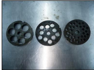
**Figura 12** – Da esquerda para direita os discos de 22, 14 e 8 mm respectivamente utilizados para trituração da matéria-prima.
