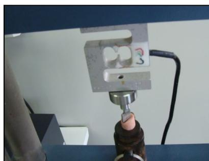
**Figura 20** – Teste de compressão (A) e teste de cisalhamento (B) das amostras de presunto de frango.
