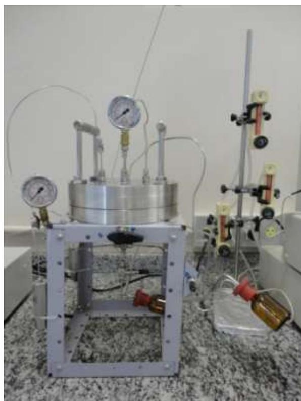
Figura 11. Fotografia do módulo de separação com membranas, os rotômetros e os frascos coletores.
