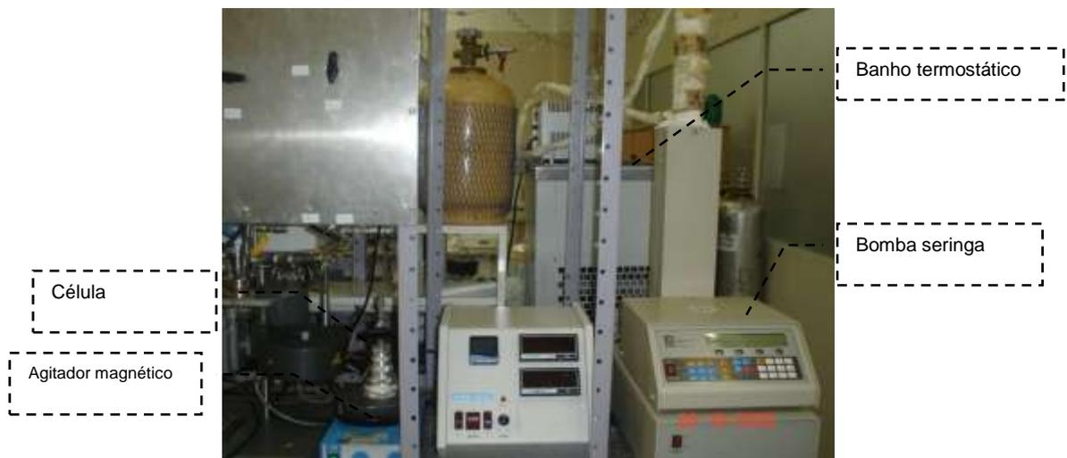
Figura 7. Fotografia geral da unidade de alimentação da célula usada para a realização dos testes de dessorção.
