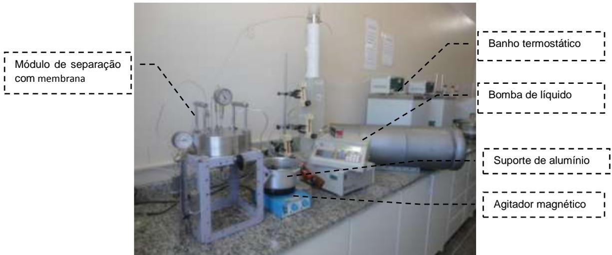
Figura 12. Fotografia geral da unidade de separação com membrana com gás GLP.
