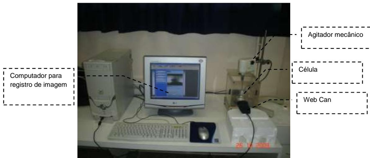
Figura 8. Fotografia da unidade de dessorção e do sistema de aquisição de imagens para os teste de dessorção.
