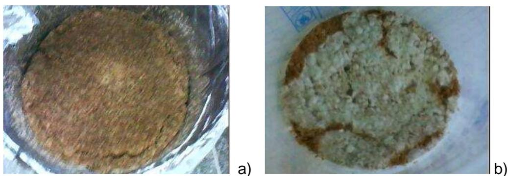
**Figura 6** - Aparência do meio fermentado em biorreator de leito fixo com FS+CA (a), e a aparência do meio fermentado em béquer com FS (b).
