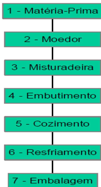
Figura 2. Fluxograma de produção de linguiça calabresa.
