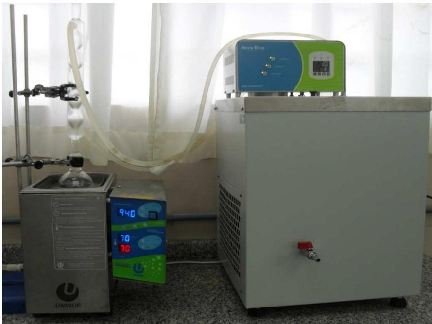
**Figura 3. 1:** Vista geral do aparato experimental utilizado para produção enzimática de biodiesel em solvente orgânico em sistema de ultrassom.
