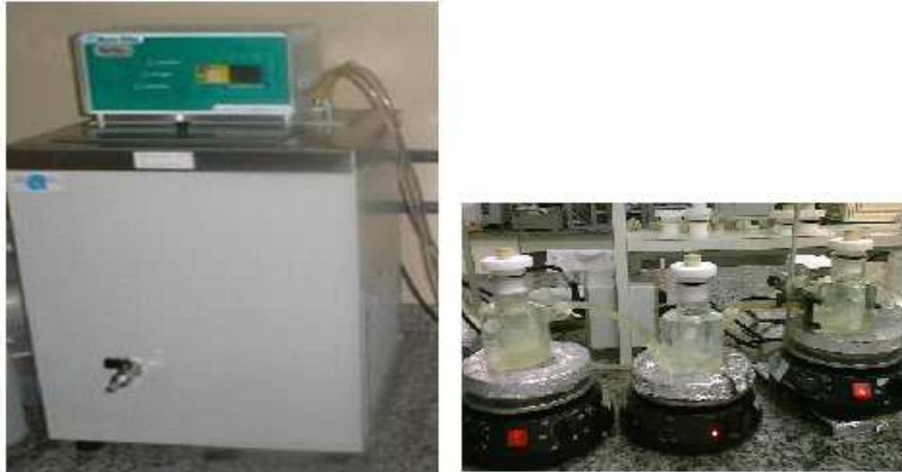
Figura 12 - Sistema composto de um banho termostático e reatores utilizados para a determinação da atividade enzimática.
