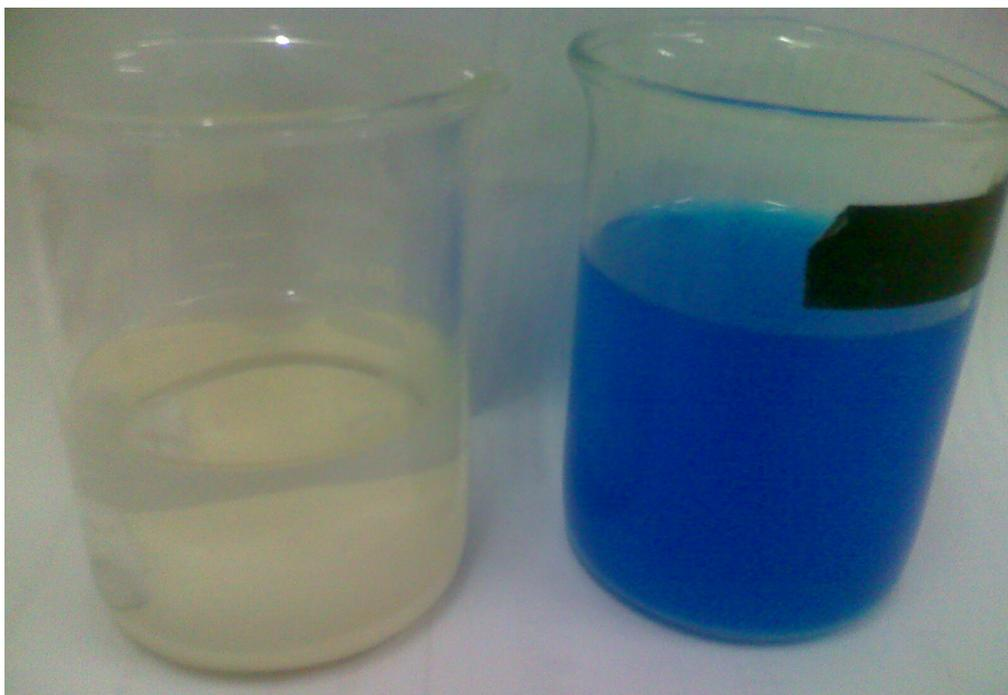
**Figura 8-** Amostra de calda bruta e após aplicação do POA empregando como promotor do radical hidroxila cal.
