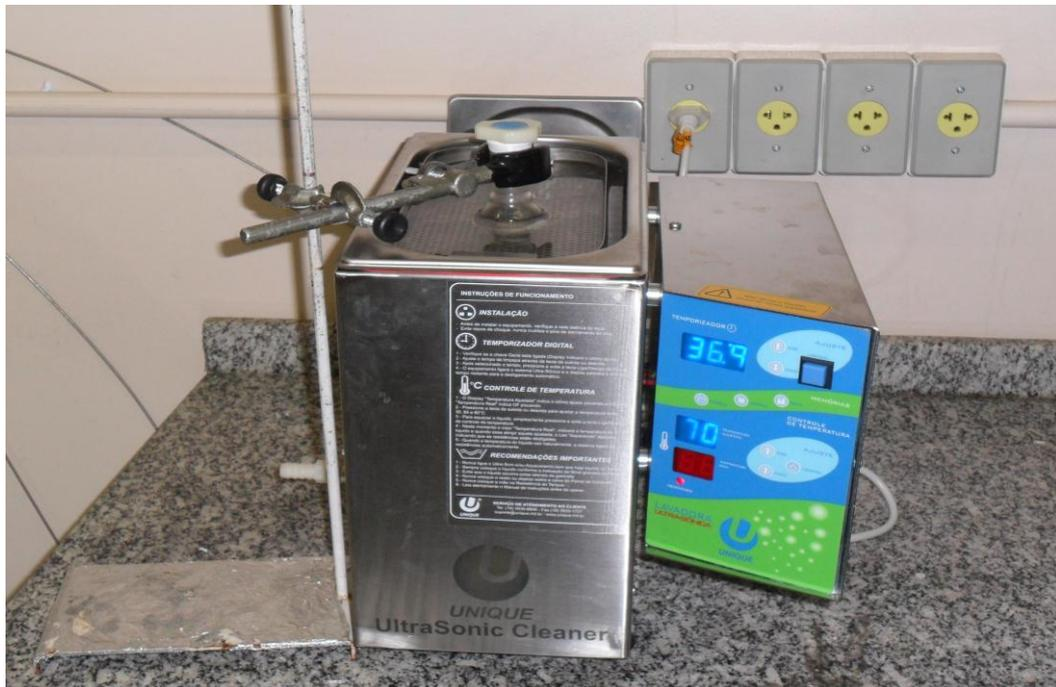
**Figura 8:** Aparato experimental utilizado para a produção enzimática de biodiesel enzimático em banho de ultrassom.
