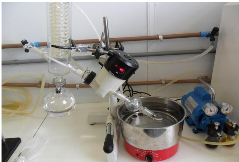
**Figura 9:** Aparato experimental utilizado para a evaporação do álcool etílico não reagido e hexano após lavagem da enzima.
