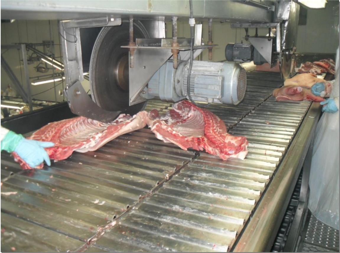
Figura 7 – Espostejamento das carcaças (sala de cortes)
