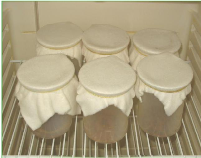
**Figura 2** – Béqueres de polipropileno utilizados para o processo fermentativo
