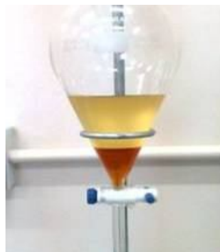
Figura 4.3 – Separação das fases – biodiesel metílico de pinhão manso.
