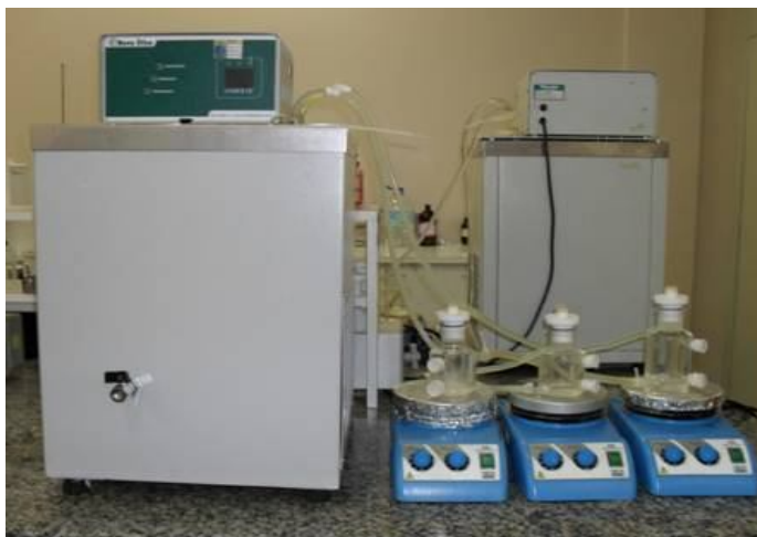
Figura 3.2 - Vista geral do aparato experimental de equilíbrio líquido-líquido.
