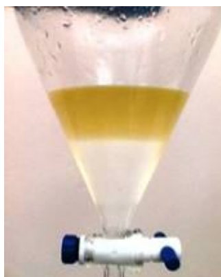
Figura 4.4 – Detalhe da purificação do biodiesel.
