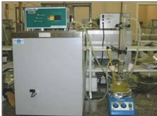
Figura 3.1 – Aparato experimental utilizado para a esterificação e produção de biodiesel.
