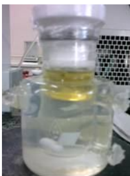
Figura 3.3 – Célula de equilíbrio líquido-líquido, contendo o sistema biodiesel etílico de pinhão manso + água + etanol em decantação a 60 °C.
