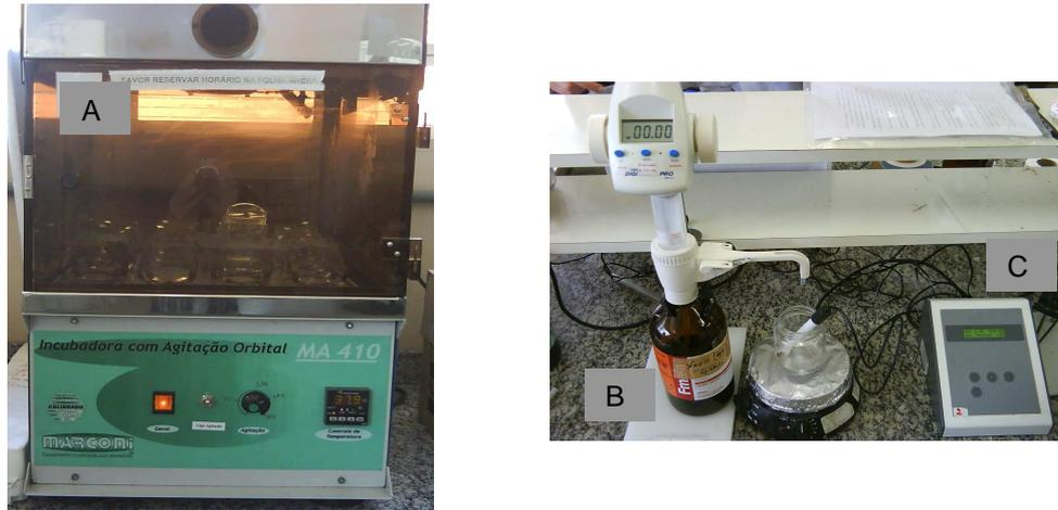
**Figura 2** - Equipamentos utilizados para medida de atividade enzimática. A- shaker; B- titulador (bureta automática); C- pHmetro.
