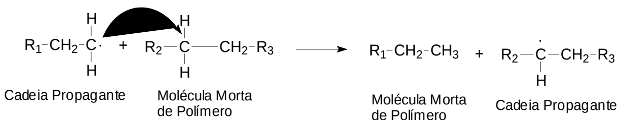
Figura 3 – Exemplo de ramificações devido à transferência de cadeia intermolecular.
