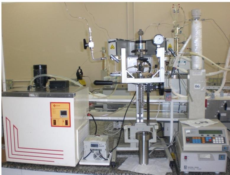
**FIGURA 3.6** – Vista geral da unidade experimental 2 para transesterificação enzimática de óleo de soja em propano pressurizado.
