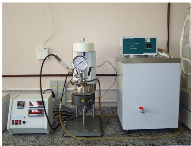
**FIGURA 3.3**– Vista geral da unidade experimental 1 para transesterificação enzimática de óleo de soja em propano pressurizado.
