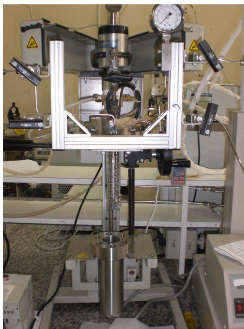
**FIGURA 3.7** – Vista do Reator (Autoclave Engineers) utilizado para transesterificação enzimática de óleo de soja em propano pressurizado.
