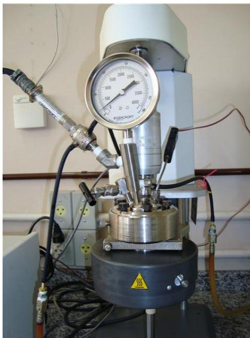
**FIGURA 3.4** – Vista do Reator (Parr) utilizado para transesterificação enzimática de óleo de soja em propano pressurizado.
