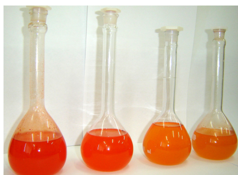
Figura 9 Aspecto visual da solução de carotenoides após extração e solubilização em metanol.
