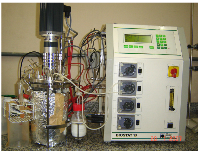
Figura 6 Biorreator utilizado na bioprodução de carotenoides.
