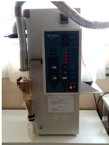
Figura 7 - Vista frontal do secador por atomização
