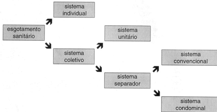
**Figura 3** - Tipos de sistemas de Esgotamento.
