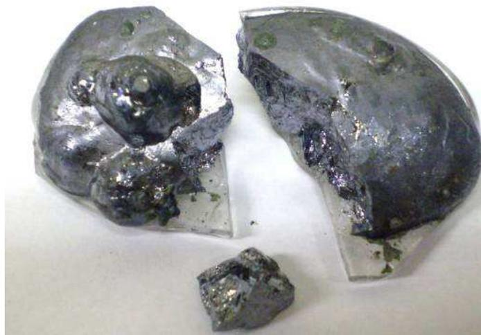
Figura 5.40 – Fotografia do lingote de silício grau metalúrgico obtido no 1º experimento.
