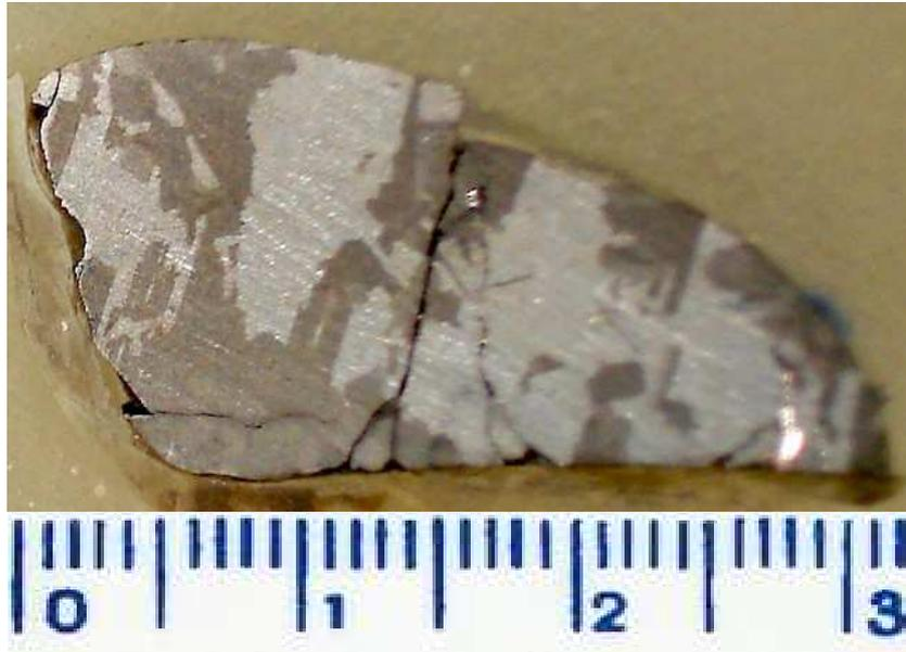
Figura 5.41 – Macrografia do lingote de silício grau metalúrgico obtido no 1º experimento – seção longitudinal (ataque químico com HF:HNO<sub>3</sub> 1:6).
