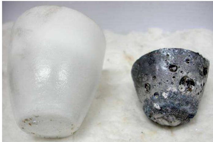
Figura 5.44 – Fotografia do cadinho e do lingote de silício grau metalúrgico obtido no 2º experimento.
