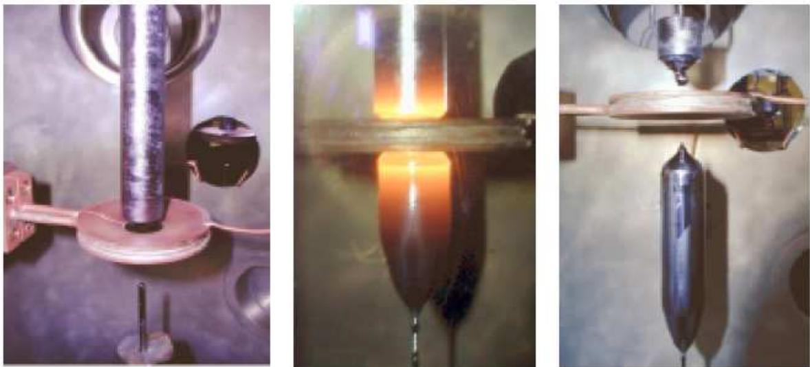
Figura 3.3 – Fotografia do processo *Float Zone*. (a) início, (b) crescimento e (c) final. [Ciszek, 2002].
