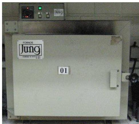
Figura 4.2 – Forno tipo mufla [Lamett, PUCRS].
