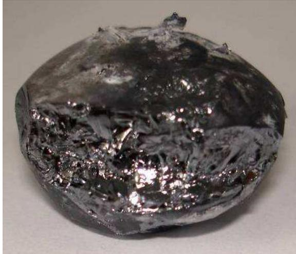
Figura 5.47 – Fotografia do lingote de silício grau solar obtido no 3º experimento.
