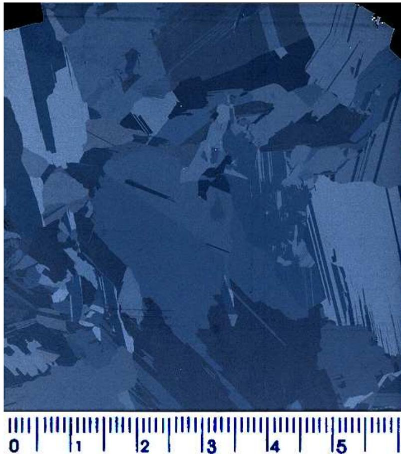
Figura 3.4 – Fotografia de uma lâmina de silício multicristalina comercial.
