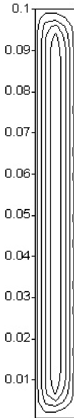
Figura B.2 – Função de corrente para o caso II em um tempo de t = 10 s, com uma malha de (80 \times 80) volumes
