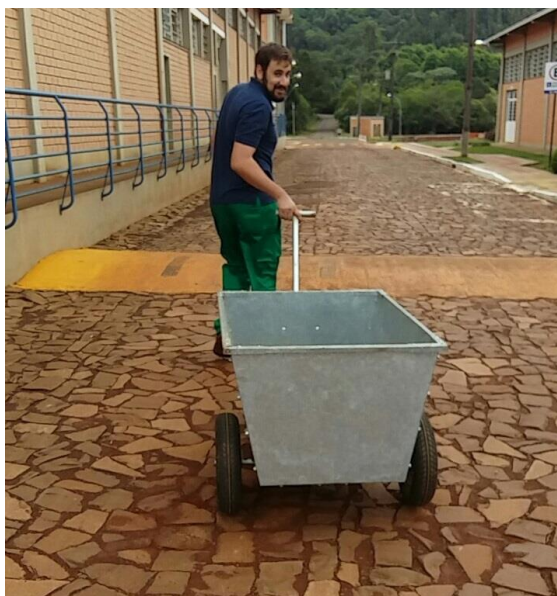
Figura 2 - Carrinho de mão tipo GIRICA para recolhimento do resíduo sólido orgânico
